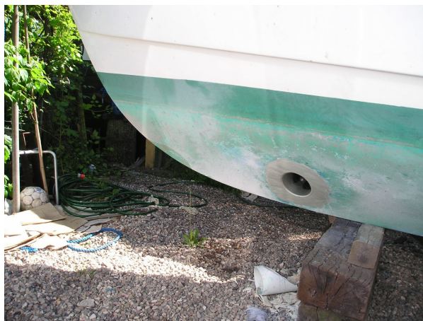
Hullet i stævnen, efter monteringen.
